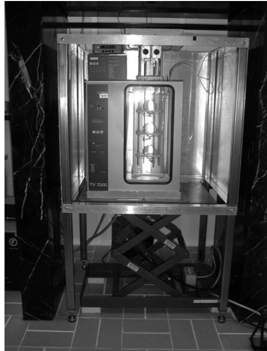
Figura 7. Sistema automático para pesada hidrostática del Laboratorio del Patrón Nacional de Densidad.
